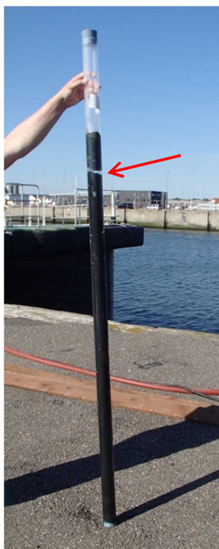
Figur 5.3. Foto af en sedimentkerne, som er udtaget i Esbjerg Havn (2. bassin) og som, med den sorte farve, er karakteristisk for havnesediment. Den røde pil markerer en gaslomme. (Foto: NIRAS).
